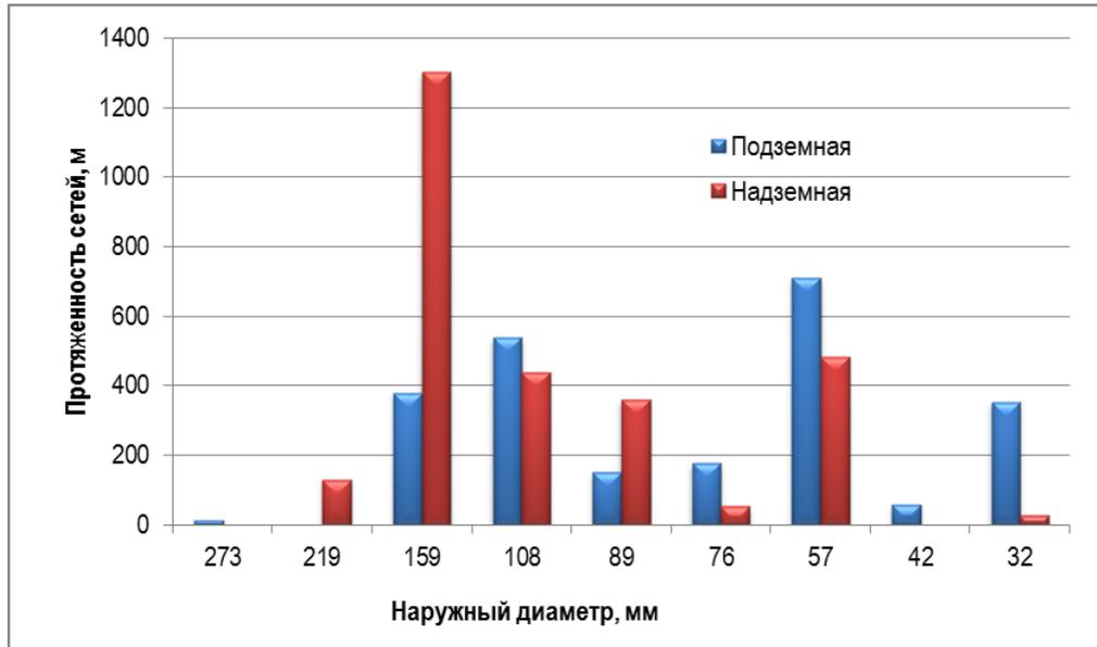
Рисунок 1.7 – Структура тепловых сетей в зоне действия котельной «ПМК» ул. Чапаева, 62а
